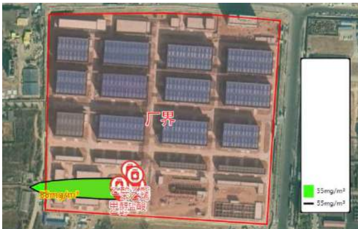
图 6.6-12 最不利气象条件下苯乙烯泄漏网格点浓度影响范围图
