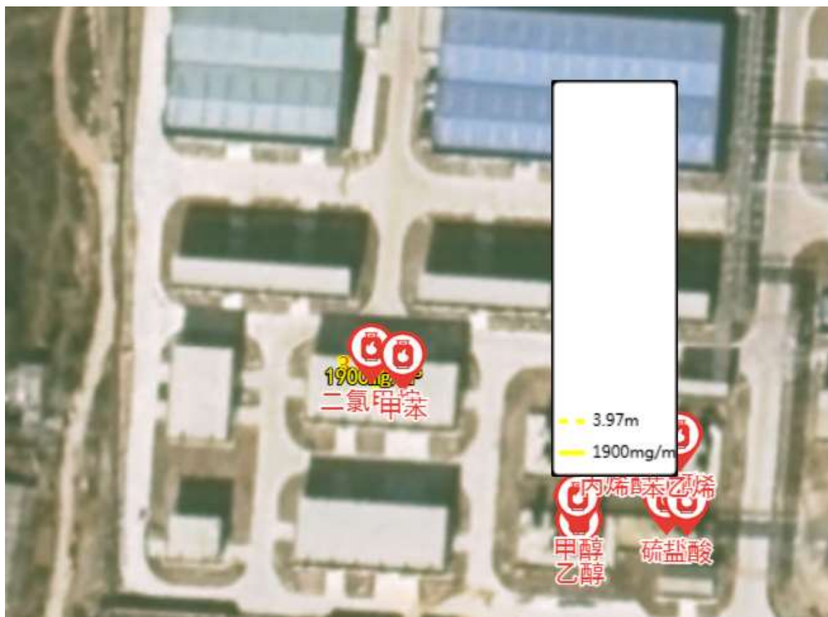
图 6.6-39 最常见气象条件下二氯甲烷泄漏毒性终点浓度的最大影响范围图
