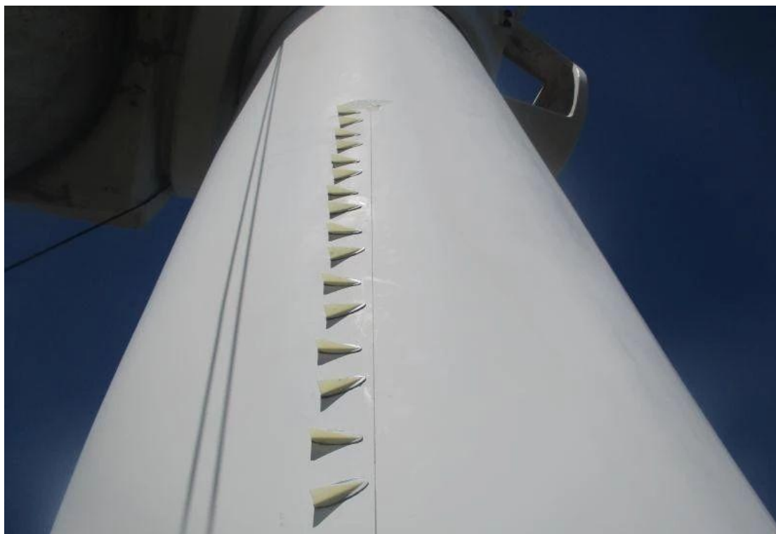
图 6-3 涡流发生器示意图
