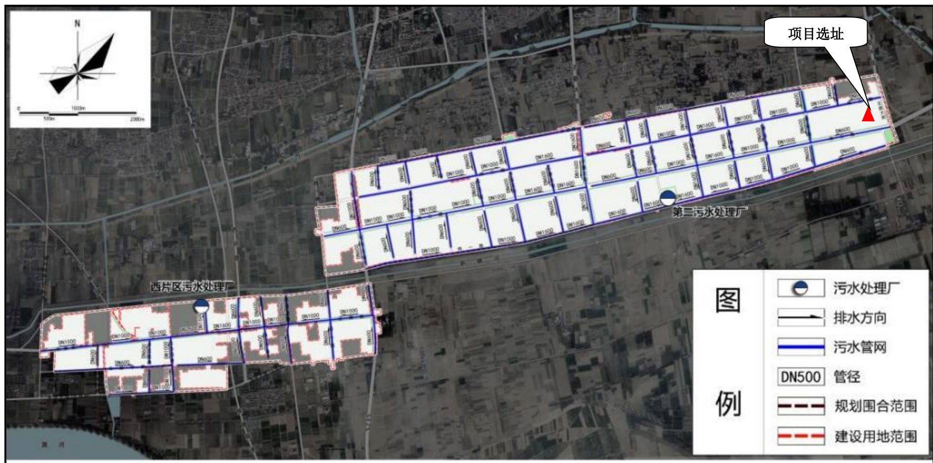
附图八 温县经济技术开发区污水工程规划图
