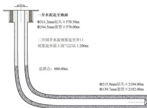
图 4-5 井身结构示意图
