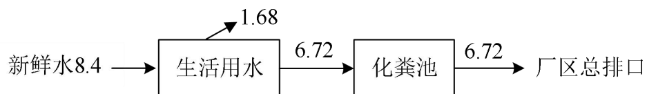
图 2-1 项目用水平衡图 \text{m}^3/\text{d}
