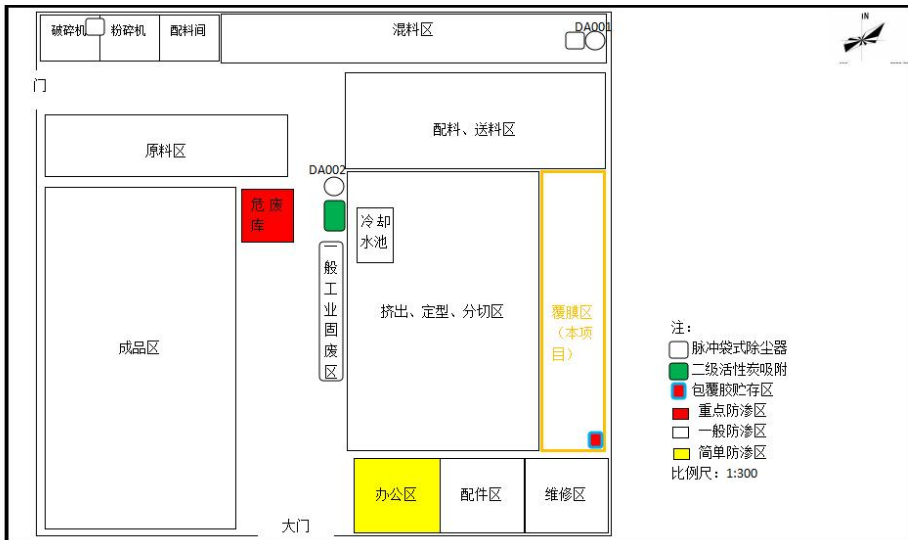
附图三(2) 扩建完成后厂区平面布局图
