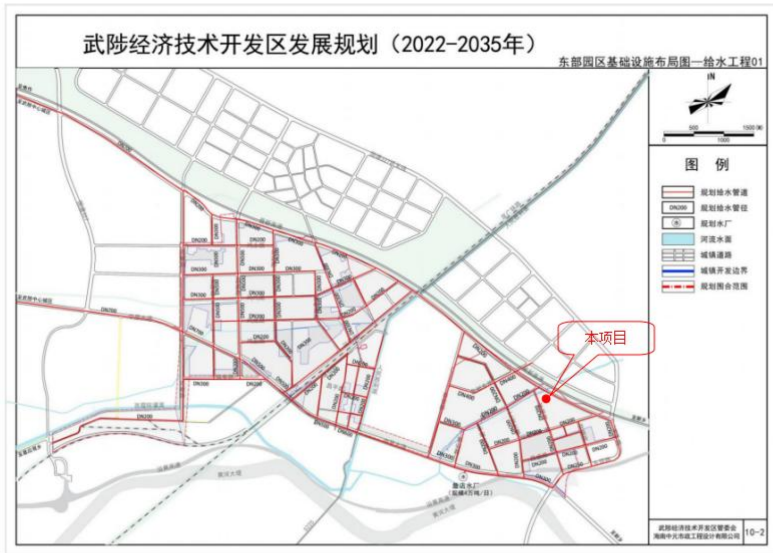
附图六 武陵经济技术开发区东部园区给水工程规划图
