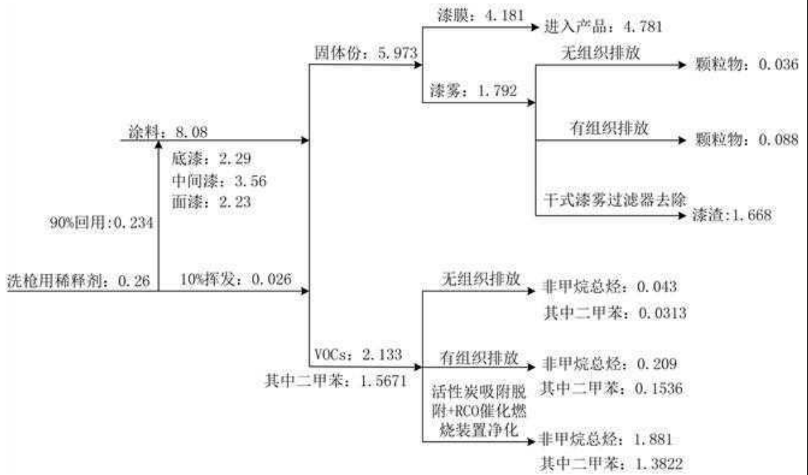
图 2-1 喷漆（含调漆、流平、洗枪）、烘干涂料物料平衡图 单位 t/a
