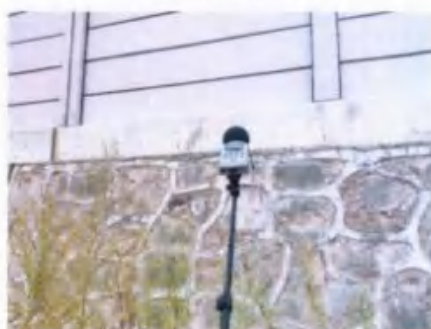
岁丰（梨园）220kV 变电站西侧偏北围墙 外声环境检测
