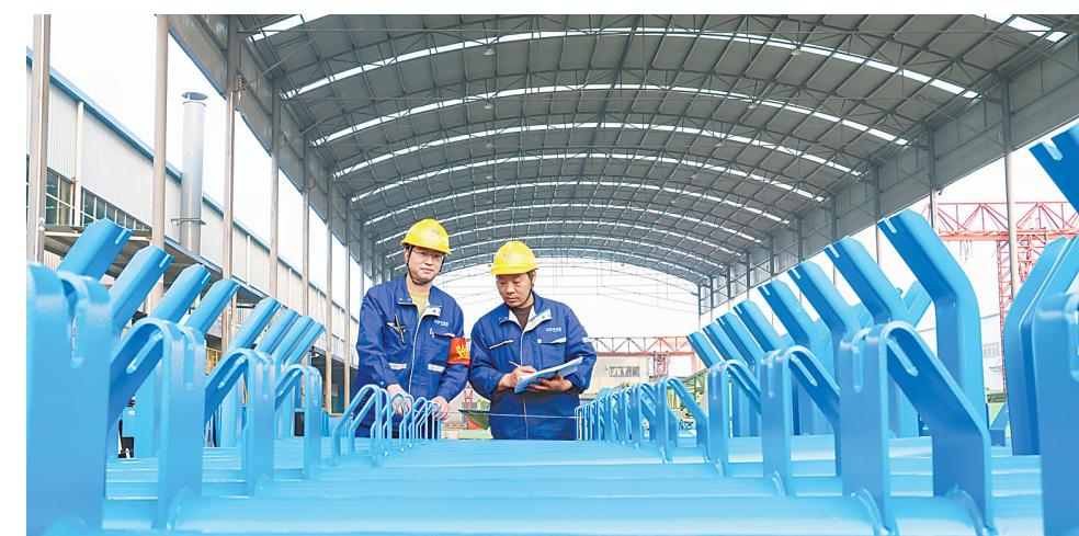
11月14日,焦作科瑞森重装股份有限公司工人正开展桁架涂装外观自检工作。该公司自主研发构建强化EPC总承包能力,产品涵盖矿山机械等5大类20余个系列,广泛应用于煤矿、港口、电力等领域,业务版图遍及全球30余个国家。
