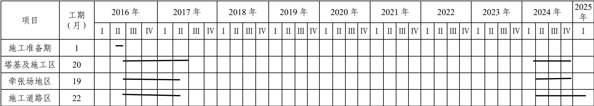
图 2-2 主体工程施工进度计划横道图（月份）
