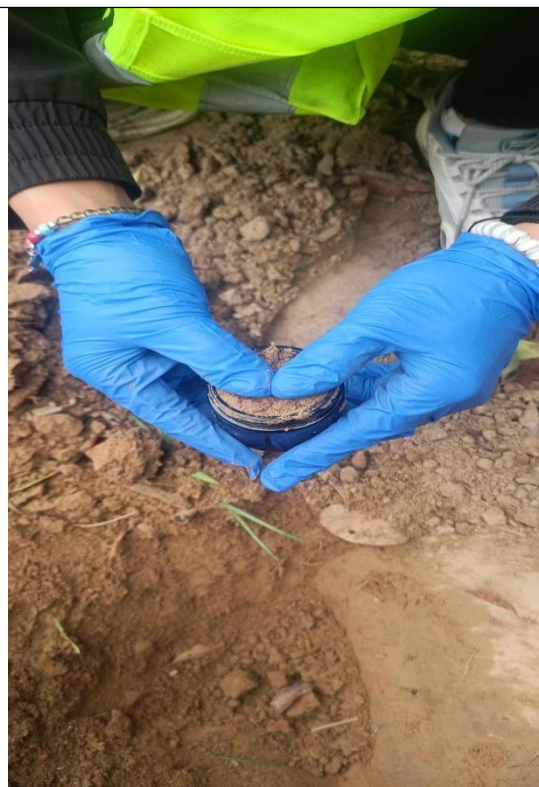
半挥发性有机物取样填满、压实
