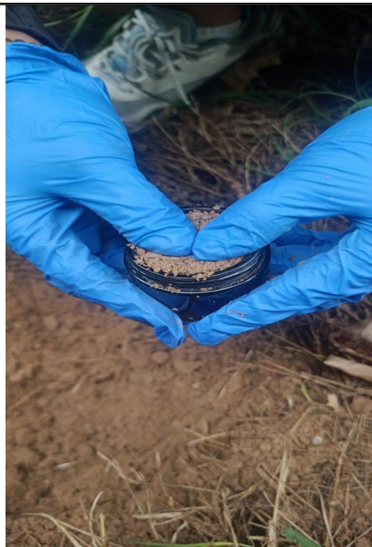
半挥发性有机物取样填满、压实
