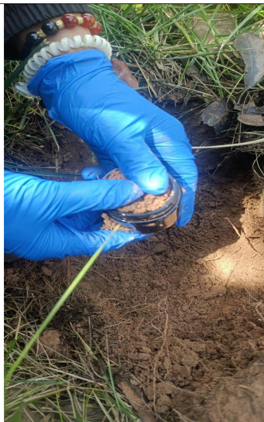
半挥发性有机物取样填满、压实
