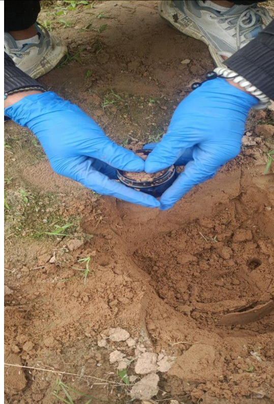
半挥发性有机物取样填满、压实
