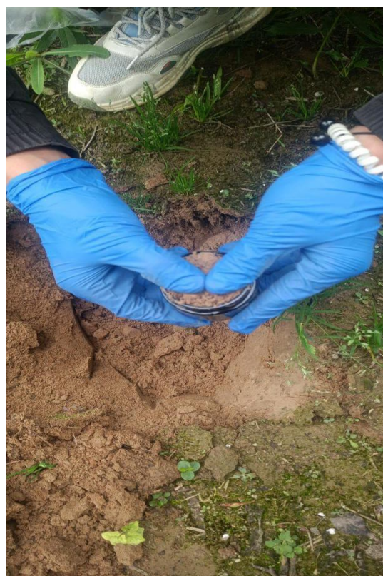
半挥发性有机物取样填满、压实
