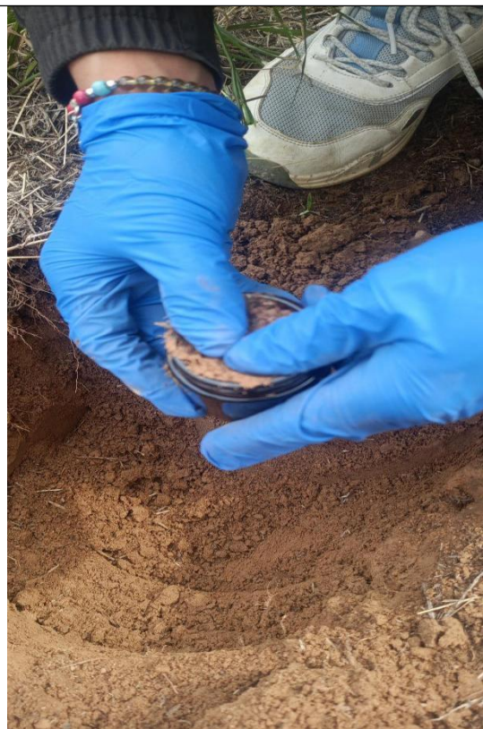
半挥发性有机物取样填满、压实
