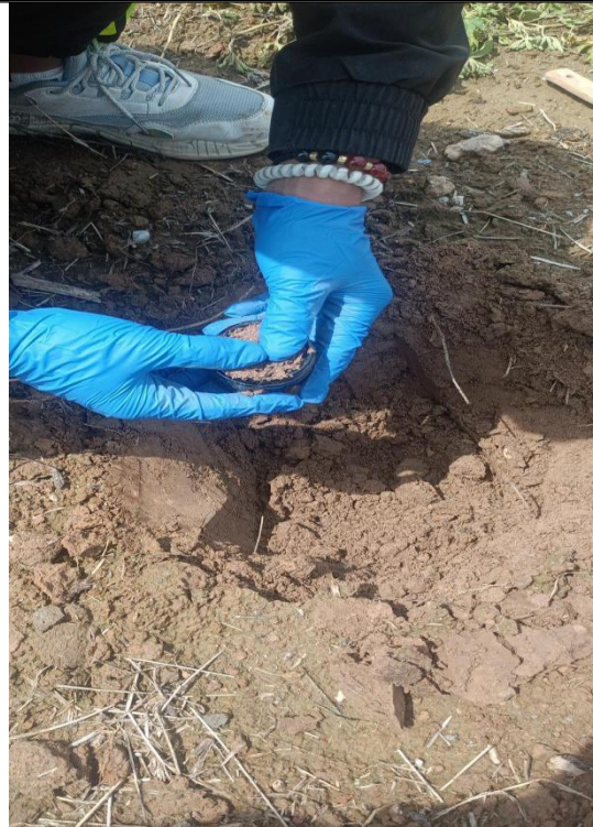
半挥发性有机物取样填满、压实
