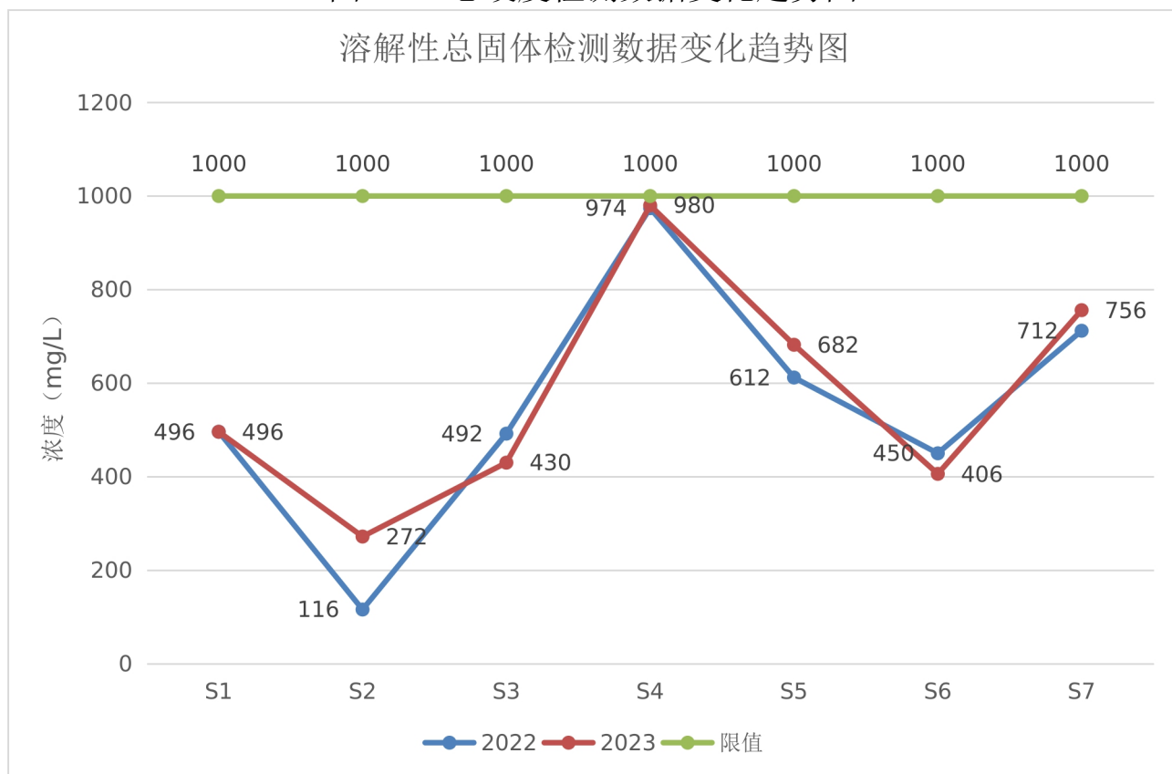
图 8-15 溶解性总固体检测数据变化趋势图
