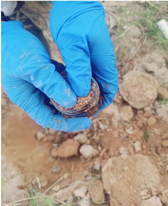
半挥发性有机物取样填满、压实
