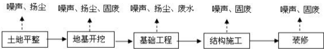
图2 本项目施工期生产工艺流程及产污环节图
