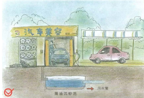
乡村汽车修理、洗车排放的污水经隔油沉砂池处理后排入污水管道
