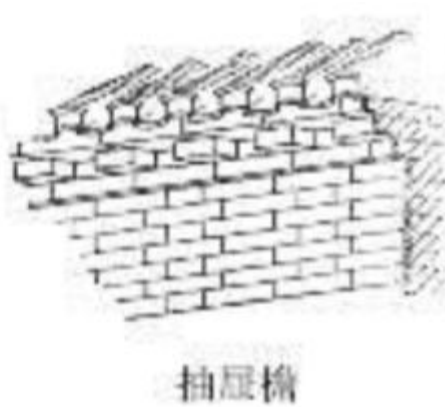
封护檐建筑的封檐做法
